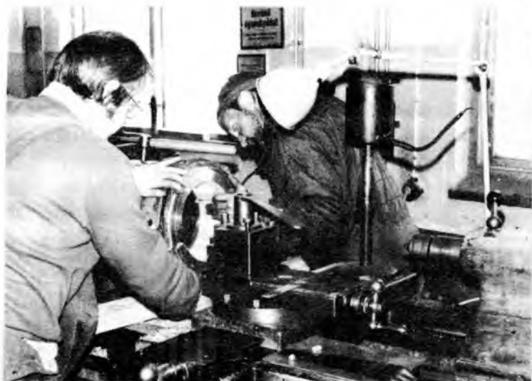
Ake Nilsson svarar vevstakslagret, med Gotthard Tingström som nyfiken åskådare och "hantlangare". Foto, maj-79: Rolf Stén
